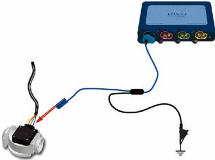
1. 利用车辆的数据资料找到传感器信号线，并将Pico示波器的通道A连接到传感器的信号线上。
