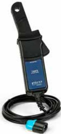
HKTA473是配备PicoBNC+接头的60A电流钳。当连接到Pico示波器时，PicoScope软件自动配置电流钳。量程切换是自动进行的，不需要用户设置。电流钳通过示波器供电，因此不需要任何电池。此外，当电流钳连接示波器时，它会被自动归零。这是一个非常紧凑的电流钳，它可以连接到其它电流钳可能无法进入的地方。
