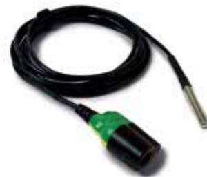
这温度探头是线性的温度测试线，测量范围为-40° C至125° C，适用于所有普通汽车和非公路用车。温度传感器封闭在一个5mm的不锈钢外壳中，以提供接触和气流测量。
