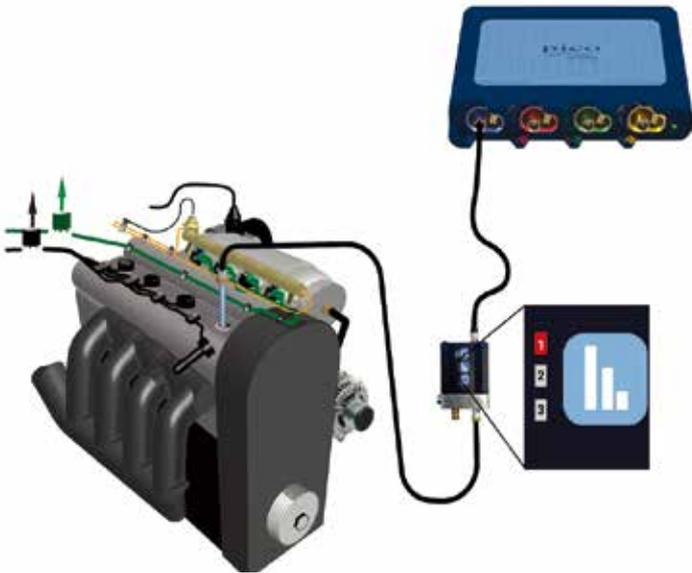
1. 禁用车辆的燃油喷射和点火系统，并将充满电的WPS500X压力传感器连接到Pico示波器的通道A上。
