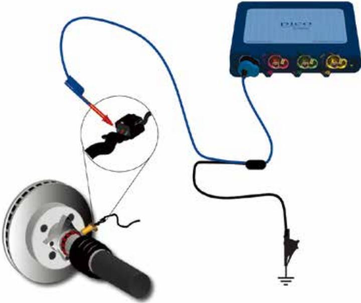
PicoScope软件设置了通道A，你也可以连接其它通道到其它传感器上，比较它们的波形。
