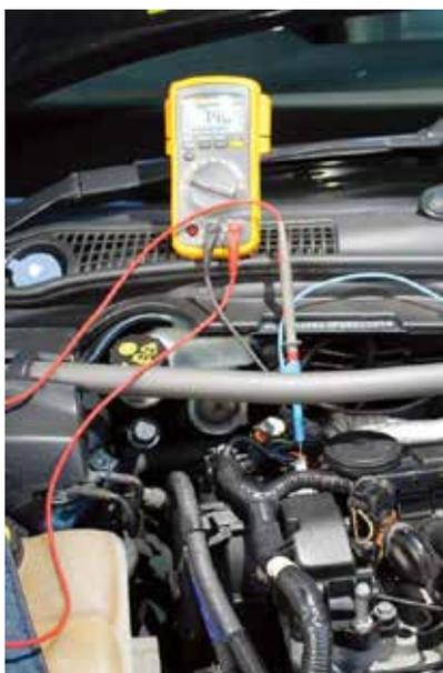
对于凸轮轴传感器，我们建议你使用后背刺针。当这个连接完成后，再连接到你的Pico示波器就很简单了。
